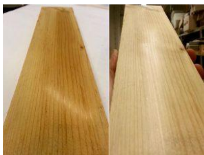
KUVA. Uotilan kokeissa parafiinillä pinnoitettu terassilaudan topografinen ja sileä pinta.
